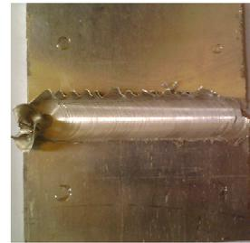
Gambar 3. Hasil pengelasan FSW
